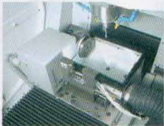
Możliwość obróbki elektrod w 4 osiach
