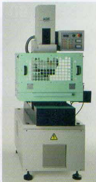
Elektrodrążarka do otworów startowych AGIEDRILL
