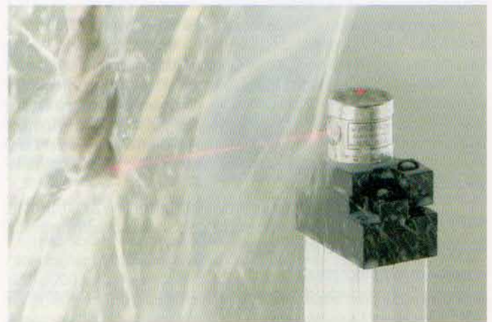
Bezdotykowy system pomiaru narzędzi NC4
