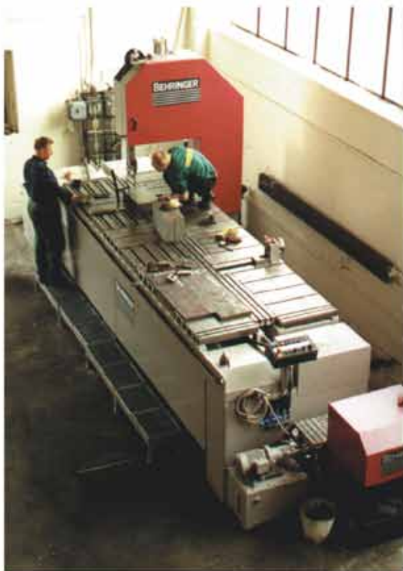
Fot. 3 Piła taśmowa pionowa pozwala ciąć blachy o grubości do 600 mm i długości ponad 4000 mm. Możemy z arkusza blachy wyciąć płaskowniki o potrzebnych szerokościach.
