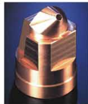
Elektroda z miedzi wykonana za pomocą aparatu podziałowo-uchylonego ATS 160 CNC firmy FEHLMANN; część kulista - za pomocą frezowania 5-osioowego symultanicznego
