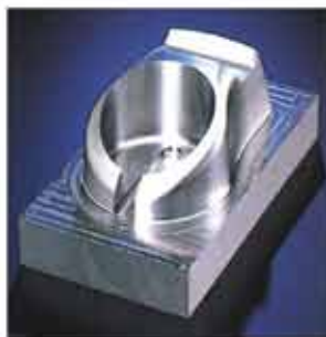
Wkładka formy wykonana z hartowanej stali 1.2343 (52 HRC)
