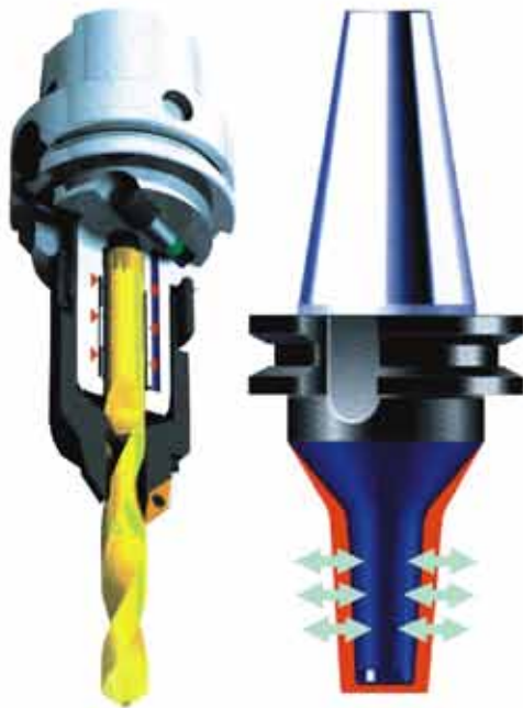
Rys. 3 Idea mocowania hydraulicznego i skurczowego.
