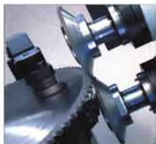
Fot. Różne formy boków zębów CNC 6F Rapide szlifuje przy jednym zamocowaniu.
