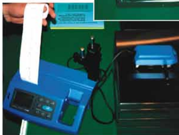
Fot. 4. Dzięki uprzejmości p. Kazimierza Połłaka z ITA zbadaliśmy chropowatość płyt testowym HOMMEL T 1000. Wynik Ra = 0,36 µm jest naprawdę super!
