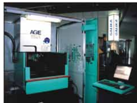
Drążarka drutowa AGIE CUT CLASSIC oferowana przez Galikę z imadłem System 3R.
