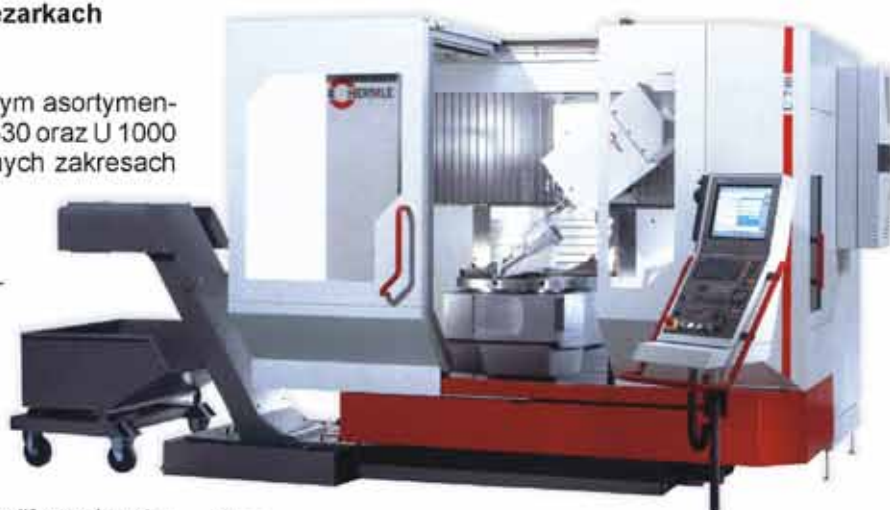
Rys. 1 5-osiowa frezarka sterowana numerycznie HERMLE U 740 zbudowana na bazie korpusu mineralnego.
