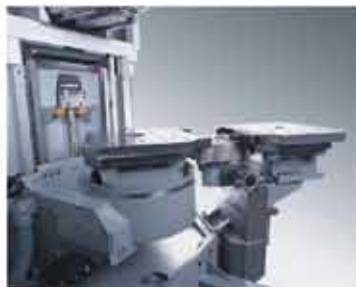
Fot. Zmieniacz palet gwarantuje krótkich czasów przebrojenia, zainstalowany pod kątem 45 w trosce o optymalny dostęp do przestrzeni obróbkowej.
