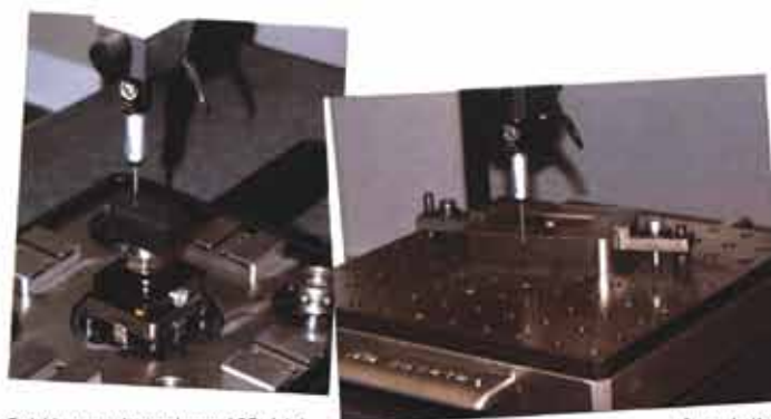
Dzięki maszynie pomiarowej 3D detal czy elektroda może być sprawdzona przed rozpoczęciem ostatecznej obróbki.
