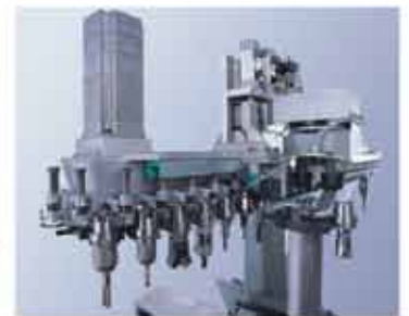
Fot. Nowy łańcuchowy magazyn narzędzi gwarantuje w połączeniu ze sterowanym CNC zmieniaczem narzędzi redukcję czasów od wióra do 4 sekund.
