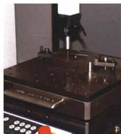
Położenie detalu na palecie jest zamierzone i przeniesione do obrabiarki w celu automatycznej kompensacji.
