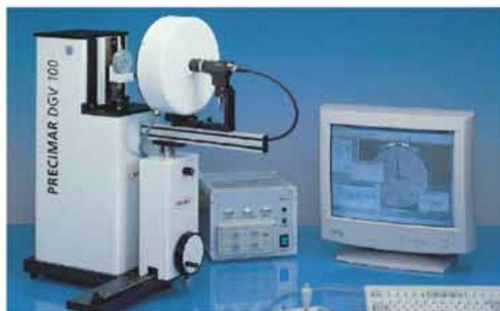
Rys. 3 Sprawdzenie czujników z PRECIMAR DGV 100
