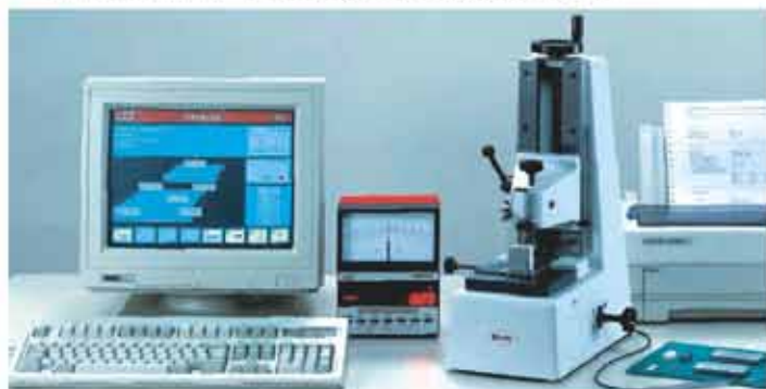
Rys. 1 Stanowisko do kontroli płytek wzorcowych 826 PC
