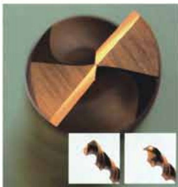
Rys. 1 Wklesły profil rowków wiórowych zapewnia optymalny spływ wiórow.
