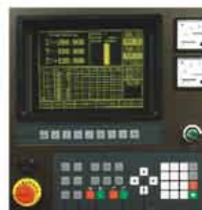
Fot 2. Przyjazny panel sterowania z wbudowaną tabelą technologii drążenia
