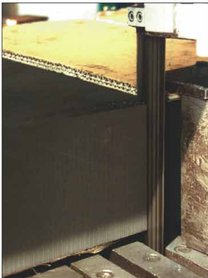
Fot 1. Cięcie grafitu piłą taśmową w naszym zakładzie.
