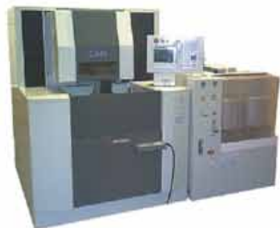
Rys. 2 - QA10 - obrabiarka WEDM-klasa High-End.
