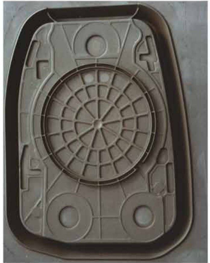
Rys. 4 Elektroda grafitowa wykonana w narzędziowni FORM-PLAST w Bydgoszczy.
