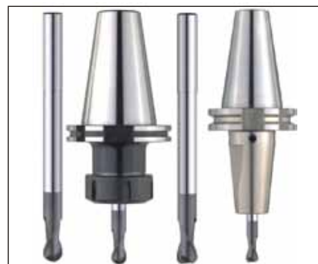
Rys. 1 Frez z węglika spiekane w wykonaniu krótkim (zamocowany) i długim: A - frez kulisty i oprawka na tulejki sprężyste, B - frez toroidalny w oprawce skurczowej.
