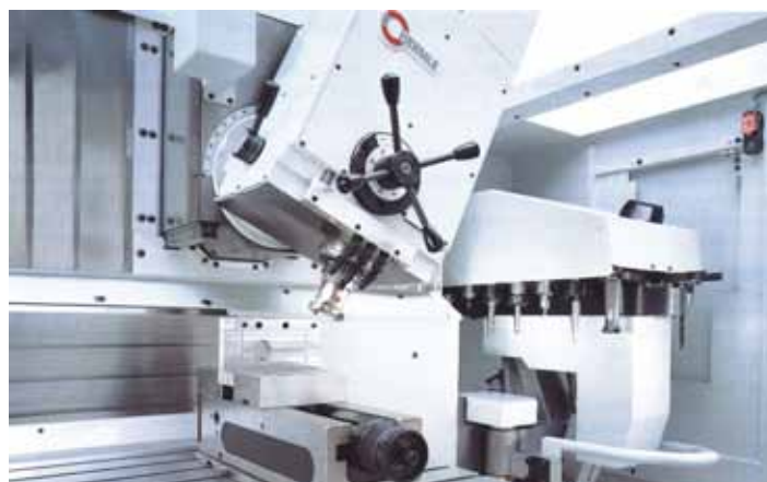
Odsunięcie magazynu powiększa przesunięcie w osi X o 245 mm
