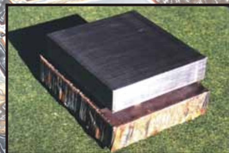
Nie palimy blach palnikiem. Piła daje gładką powierzchnię cięcia.
