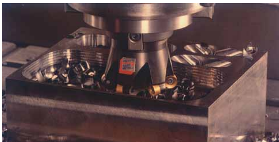
Rys. 2 - Frezowanie wglębne frezem z geometrią TWINCut.
